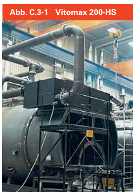
Abb. C.3-1 Vitomax 200-HS Vitomax 200-HS mit Überhitzer, 22 t/h, 10 bar, während der Fertigung, (installiert in Litauen).
