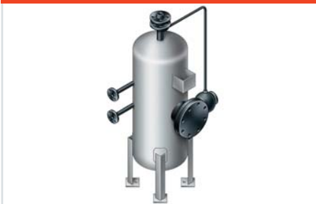
Abb. C.8.2-1 Absalzentspanner mit Laugenkühler
